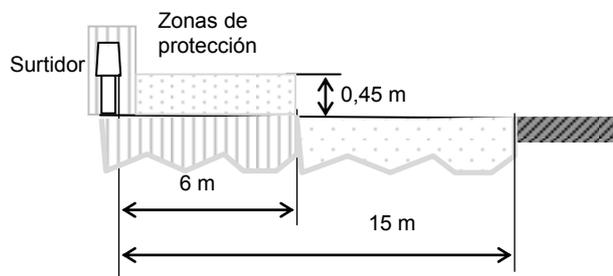
Las cámaras de inspección de sistemas de caños enterrados o emblocados para tendido de cables bajo nivel deben ubicarse a una distancia mayor a 15 m de los surtidores.
